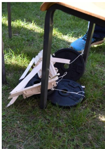
Rys. 4. Test wytrzymałości kratownicy (fot. Aleksandra Pluta)
