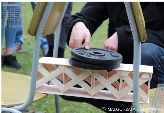
Rys. 6. Obciążanie gotowych makiet mostów; (fot. Małgorzata Ostrowska)
