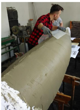
Rys. 3. Wzmacnianie konstrukcji formy – nakładanie siatki podtylnkowej
