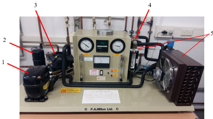
Rys. 2. Instalacja pompy ciepła i jej komponentów: 1 – sprężarka, 2 – zbiornik na skropliny, 3 – skraplacz, 4 – zawór rozprężny, 5 – dwa parowniki (wodny i powietrzny) Źródło: zasoby własne.
